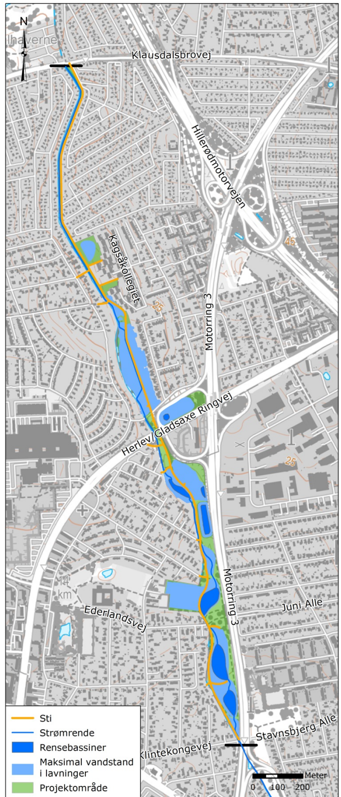
Figur 2-5 Principskitse af strømrende, rensebassiner og lavninger ved maksimal vandstand. Det er planen at etablere flest nye rensebassiner og lavninger i området syd for Herlev og Gladsaxe Ringvej. Den maksimale vandstand forventes i gennemsnit at blive udnyttet sjældnere end hvert 10. år.
