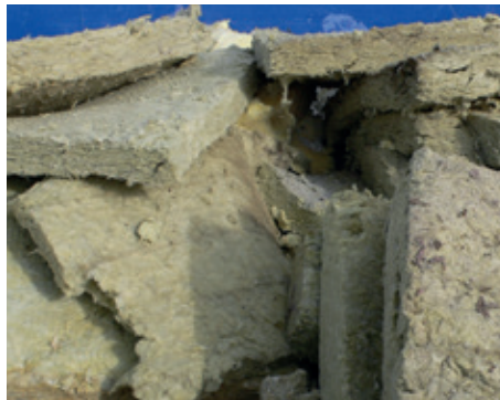
Mineraluld. Mineraluldsaffald skal håndteres som farligt affald, idet mineraluld frigiver sundhedsskadelige fibre.
