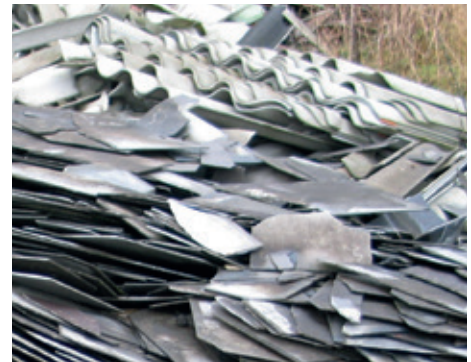
Affald af eternitplader oplagret i strid med reglerne. Eternitplader skal tages hele ned og må ikke beskadiges, da de afgiver farlige asbestfibre. Beskadede plader skal være forsvarligt emballerede i støvtæt emballage.
