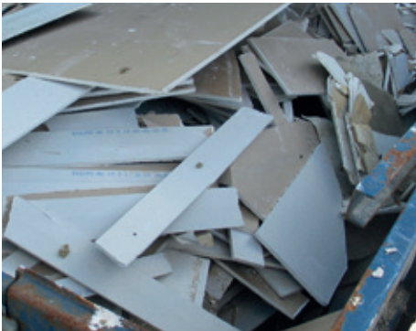
Frasorteret gipspladeaffald. Gipspladeaffald kan anvendes til fremstilling af nye gipsplader.
