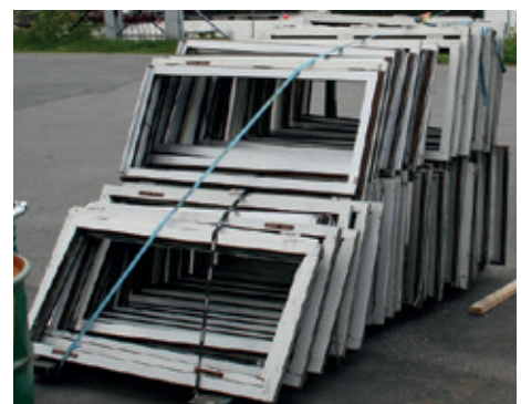
Vinduesrammer forurenet med PCB fra monterede PCB-holdige termoruder. Skal som udgangspunkt bortskaffes som farligt affald.
