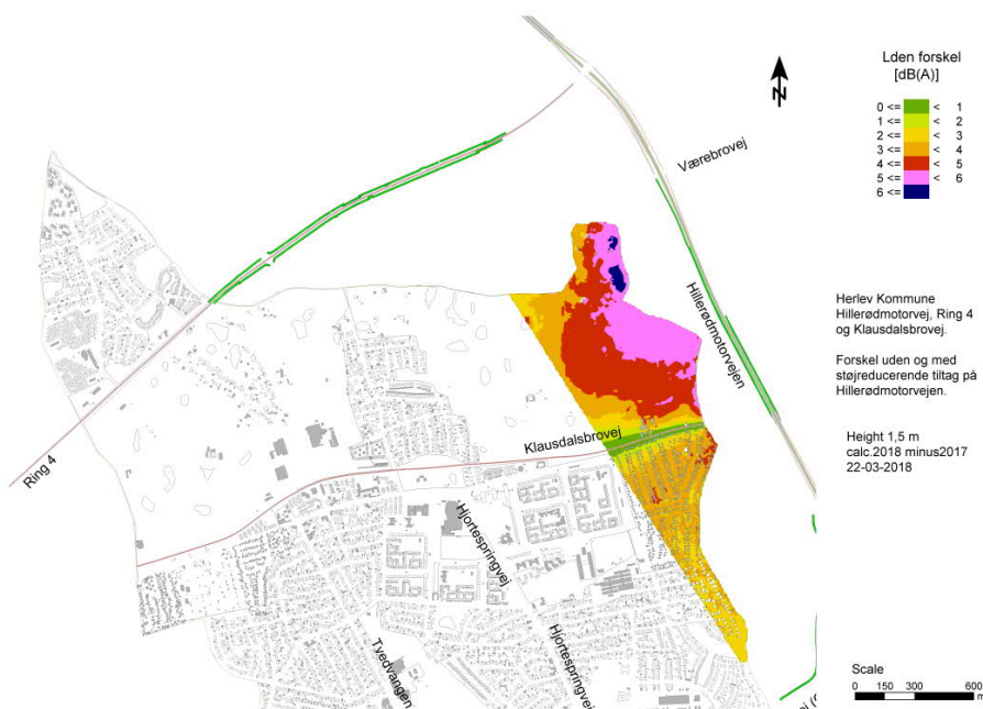
Figur 16. Støjhandlingsplan 2018-2013. Effekt af ny støjreducerende asfaltbelægning og en ny 4 m høj støjskærm langs vestsiden af Hillerød motorvejen mellem Værebrovej og Klausdalsbrovej inde i Gladsaxe Kommune "i støjrelation til Herlev".
